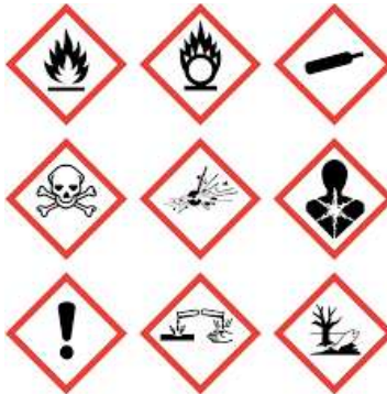
Abbildung 2: Beispiel Kennzeichnung gefährlicher Stoffe / Examples Labeling of hazardous Substances
